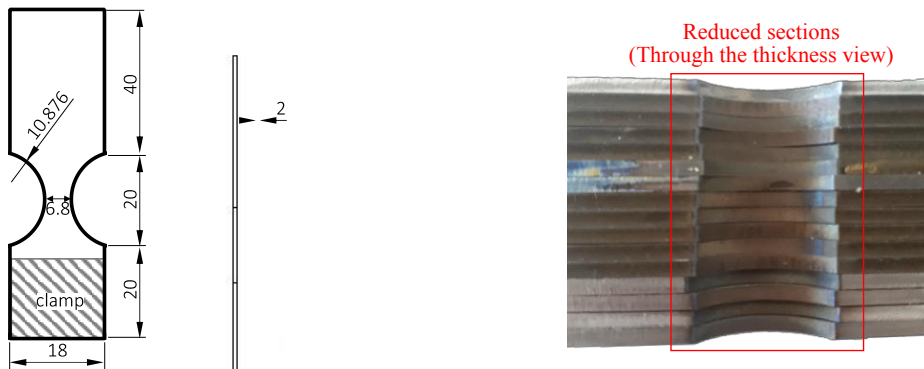
Fig 1. Géométrie et dimensions (en mm) de l'éprouvette symétrique et (à gauche) disparité de formes des sections réduites de seize éprouvettes (à droite)
